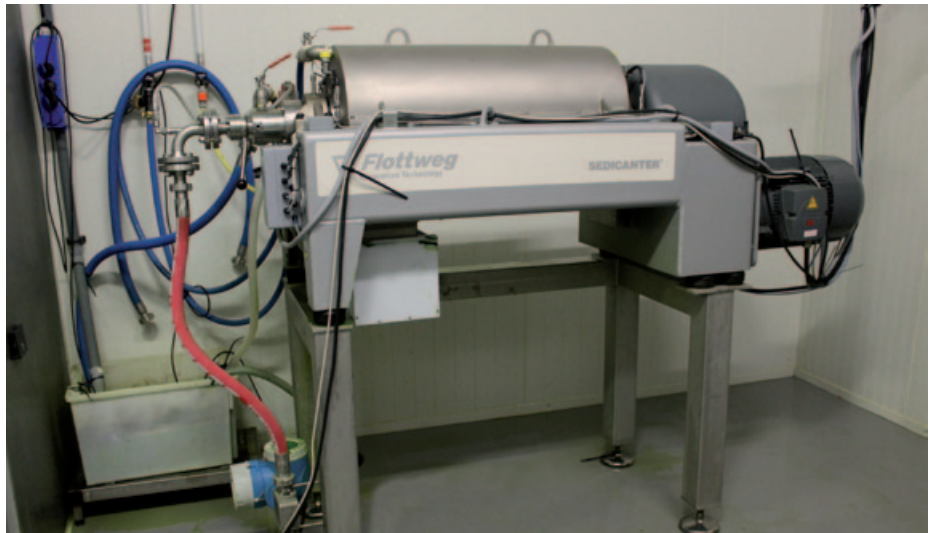
Afb. 1 De Sedicanter van Flottweg Separation Technology wordt ingezet voor het afscheiden van algen uit water
